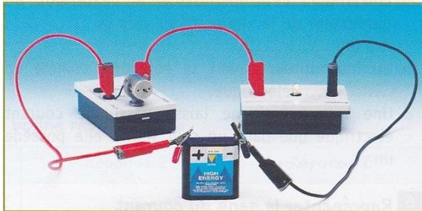
La lampe brille, le moteur tourne dans le sens des aiguilles d'une montre.
